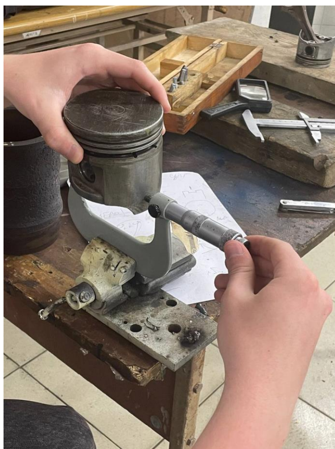
Рисунок Б.2 – Измерение диаметра юбки поршня
