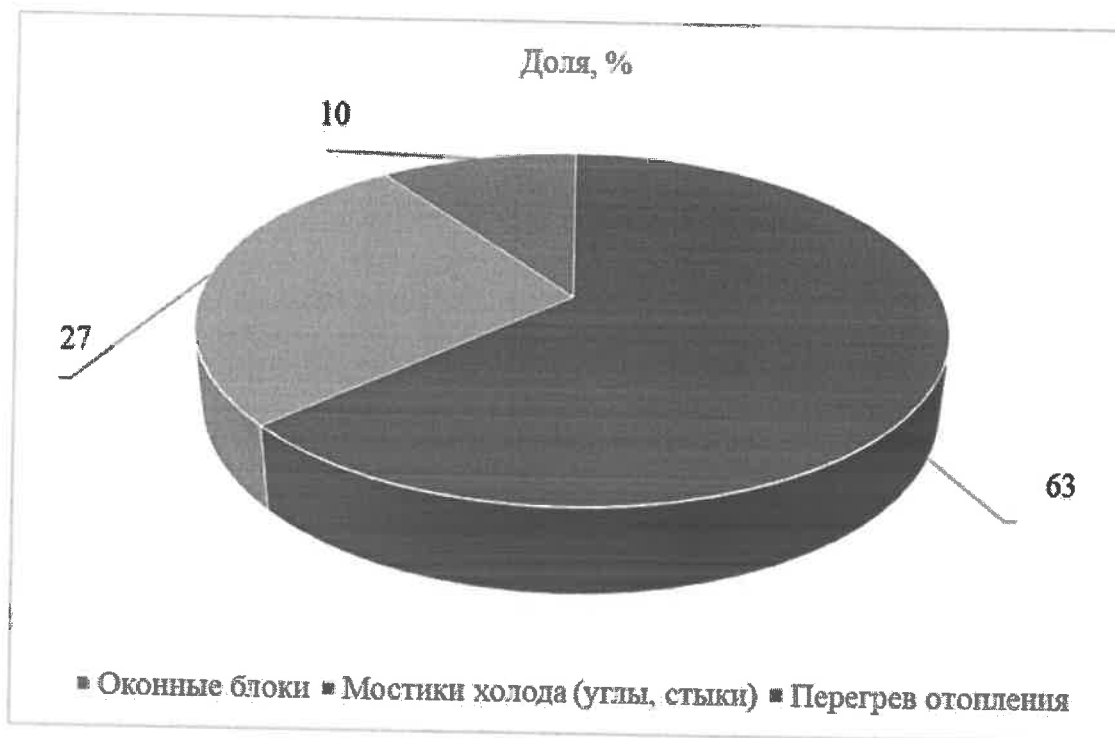
Рис. 1. Распределение выявленных тепловых дефектов по типам (диаграмма)
