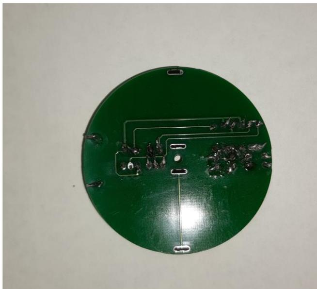
Рисунок 2 – Результат пайки контактов платы радиоконструктора
