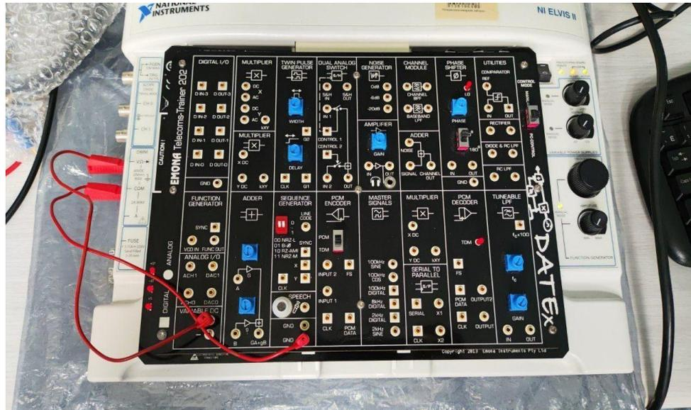
Рисунок 1– Схема для измерения положительного напряжения с подключенным модулем Variable DC
