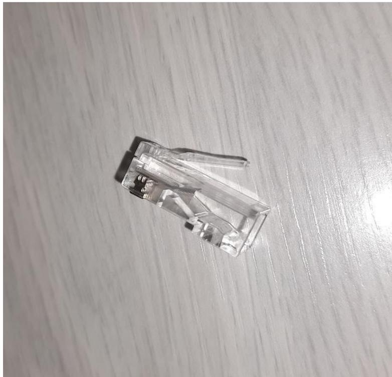
Рисунок 2 – Соединитель RJ-45
