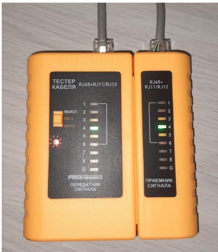
Рисунок 4 – Результат проверки тестером кабеля
