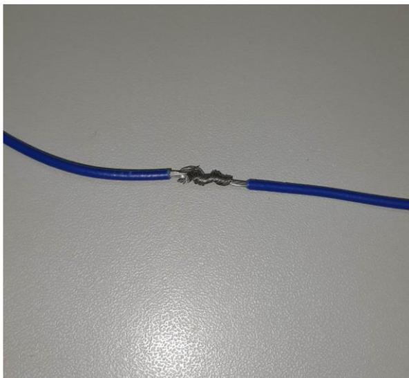
Рисунок 4 – Скручивание двух проводов
