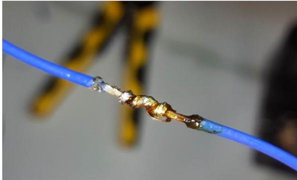
Рисунок 5 – Пайка двух соединенных скрученных проводов
