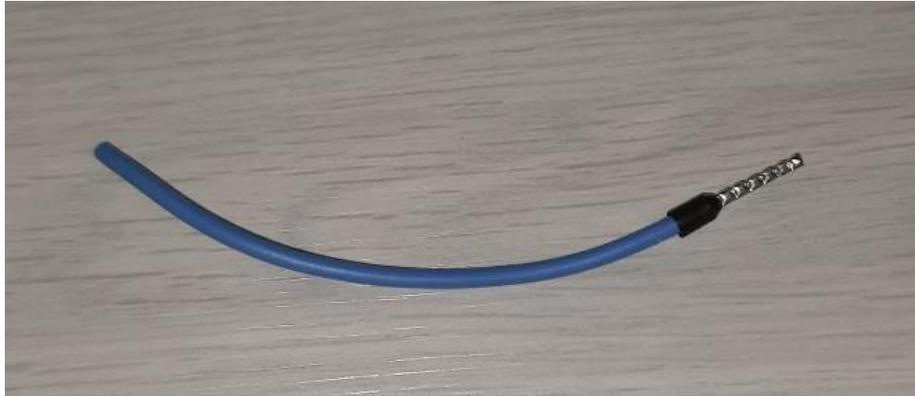
Рисунок 1 – Обжатый провод с помощью пресс-клещей
