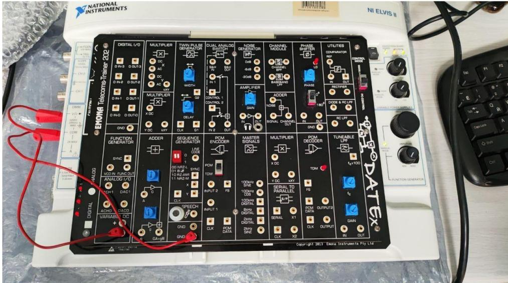
Рисунок 3 – Схема для измерения отрицательного напряжения с подключенным модулем Variable DC
