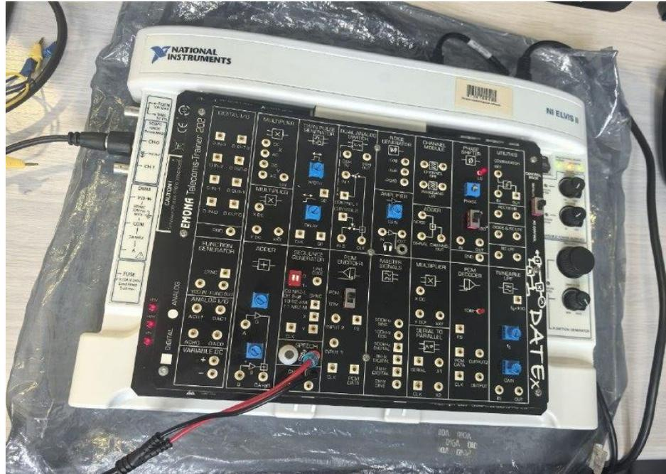
Рисунок 1– Подключен модуль речевых сигналов(Speech)
