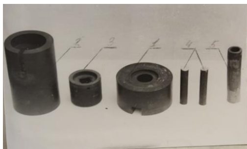
Рисунок 2. Приспособление для сварки кольцевых образцов: 1 - основание; 2 - корпус; 3 - втулка; 4 - образцы; 5 - шток;
