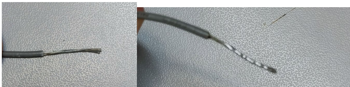
Рисунок 1 – Скрученный провод (слева) и залуженный провод (справа)
