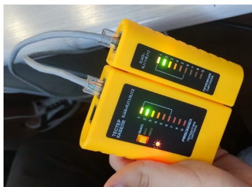
Рисунок 5 – Проверка в тестере-кабеля
