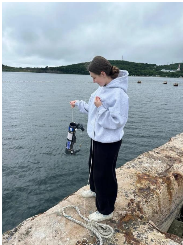
Рис. 4 Процесс применения прибора для взятия проб воды (батометра) Составлено автором
