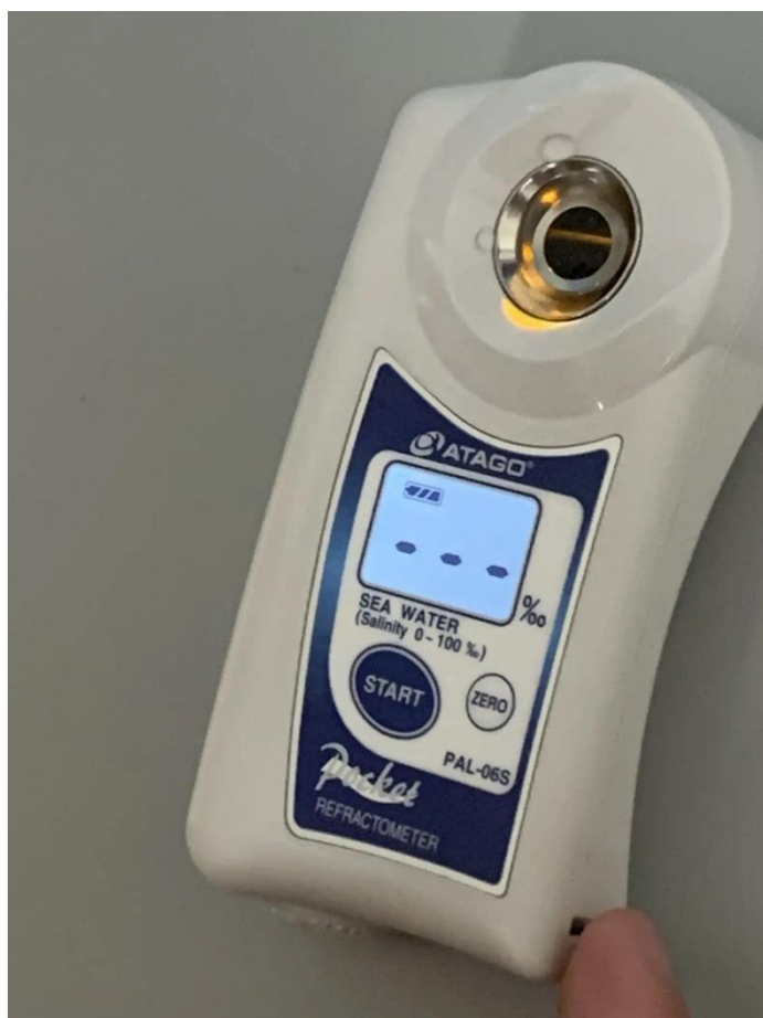
Рис. 5 Цифровой рефрактометр для измерения солености воды.
