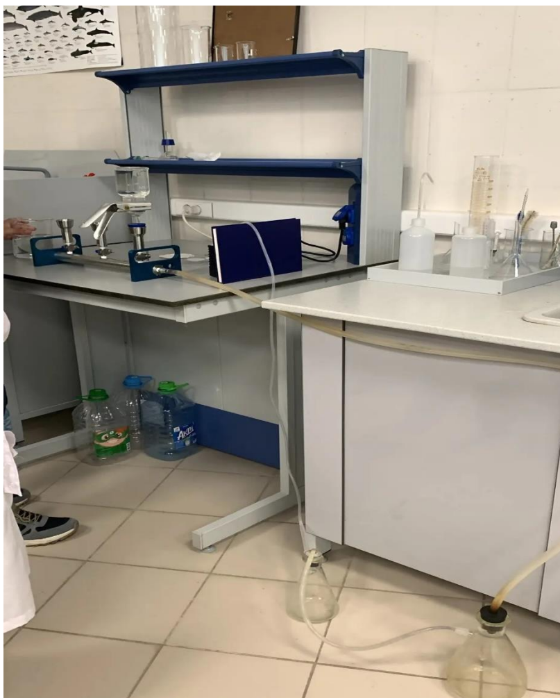
Рис. 3 Лабораторный прибор вакуумного фильтрования (вакуумная фильтрационная гребёнка)
