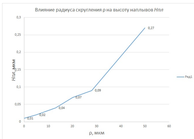
Рисунок 4 - Влияние радиуса скругления \rho на высоту наплывов H_{пл}
