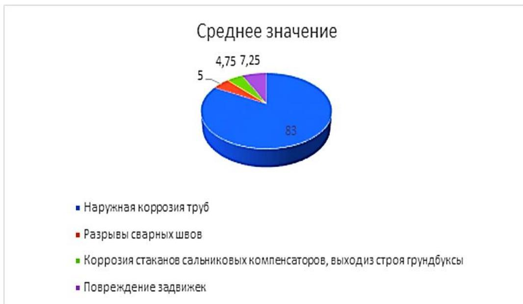
**Рис. 1. Классификация отказов на теплосетях**
