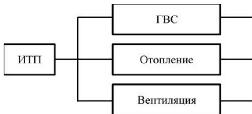
**Рис. 2. Подключение систем отопления, вентиляции и ГВС к ИТП**
