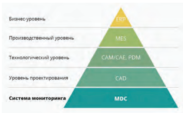
Рис.1. Пятиуровневая система автоматизации производства
