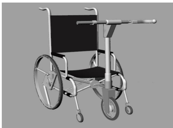
Рис. 4. 3D модель инвалидного транспортного средства
