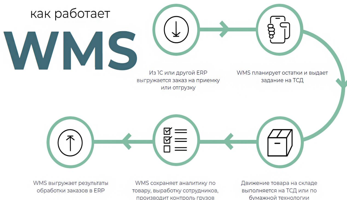
Рисунок 6 – принцип работы WMS системы
