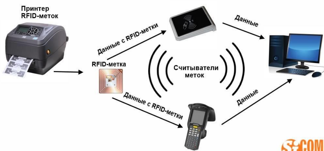
Рисунок 5 – принцип работы RFID системы
