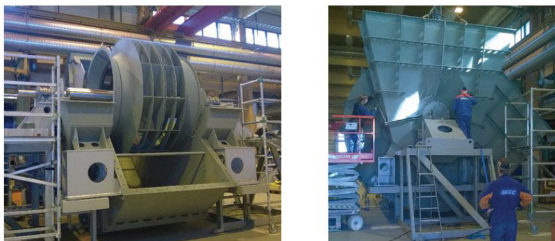
Рис. 2. Вентиляторы большой мощности (дымососы) компании КОЖА.
