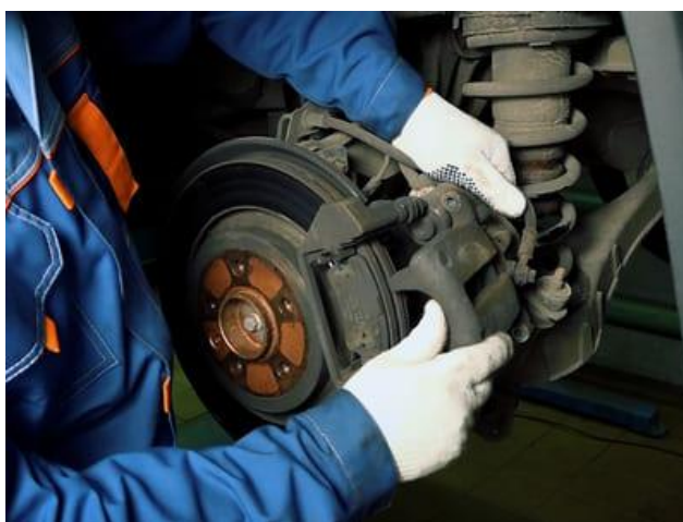
Рисунок 17 – Замена тормозных колодок
