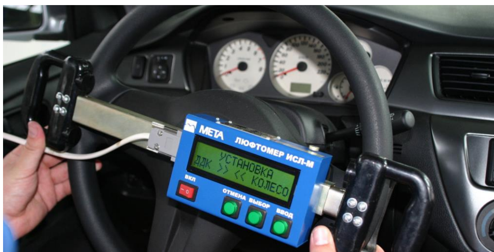
Рисунок 13 – Диагностика рулевого управления
