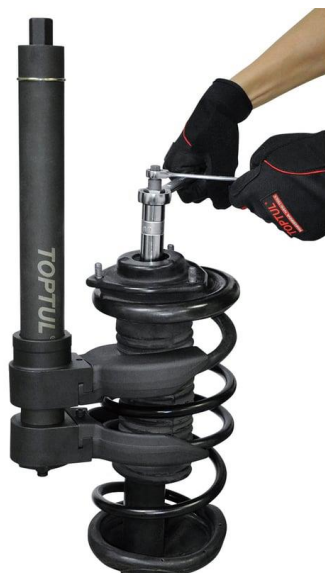
Рисунок 18 – Стяжка пружины амортизатора
