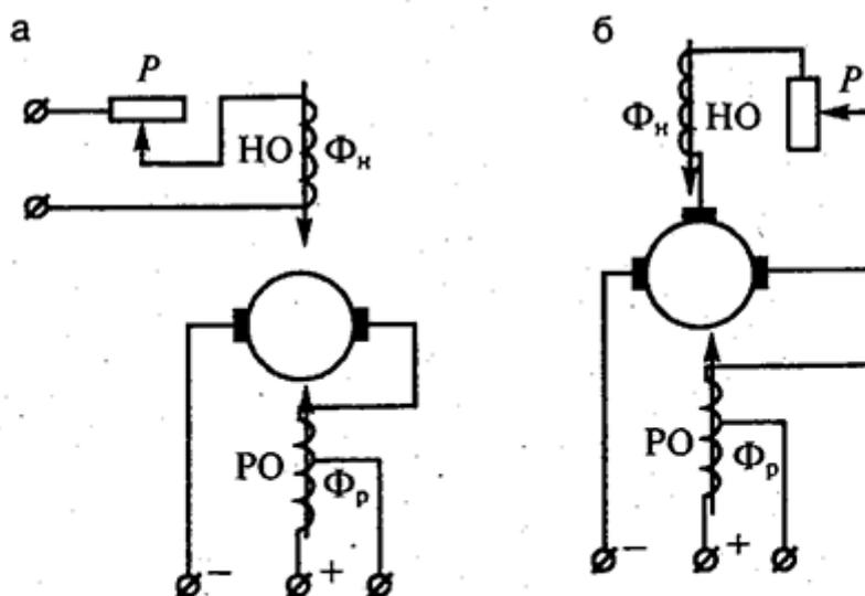
Принципиальные электрические схемы сварочных генераторов:
