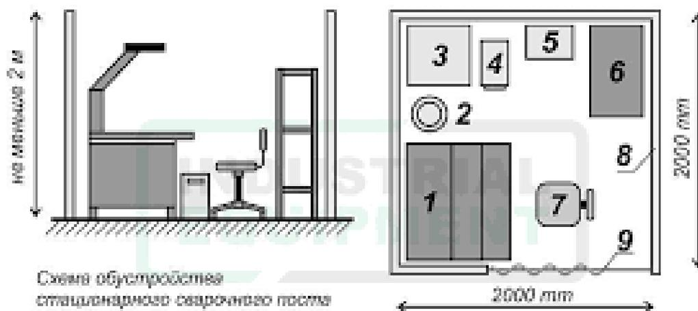
1- стол сварщика; 2- печь / пенал прокали электродов; 3 источник сварочного тока; 4- ящик для электродов; 5- ящик для инструмента; 6 - стеллаж для готовых деталей и сварных узлов; 7- стул сварщика; 8 - стены кабины; 9- ширма из брезента.
