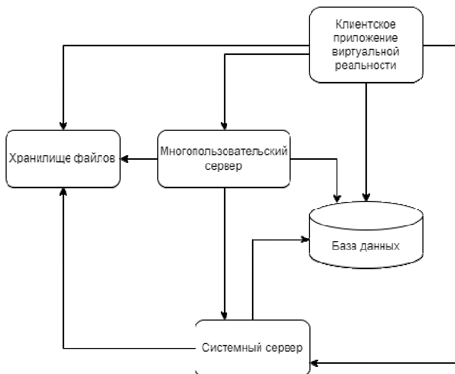
Рис. 5. Схема взаимодействия компонентов системы
