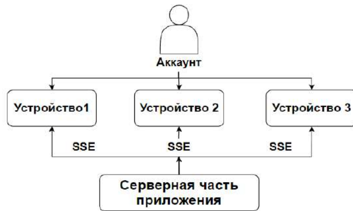
Рис. 3. Использование SSE соединения в спроектированном приложении
