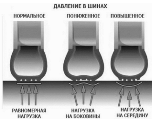
Рис. 1. Зависимость сцепления шин с дорогой от давления в них
