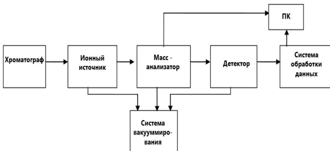
Рисунок 3 – Схема основных узлов хромато-масс-спектрометра
