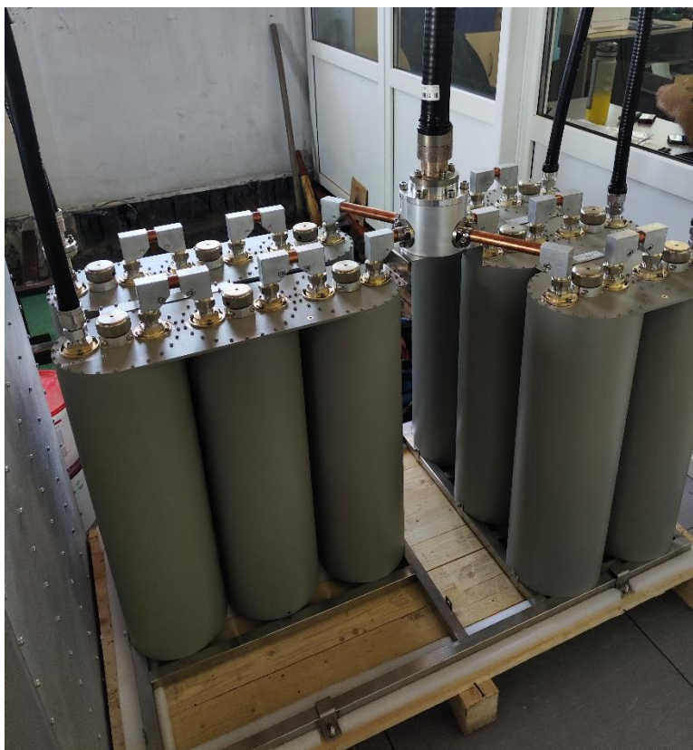
Рисунок 14 – Устройство сложения сигналов ( 107,7 \text{ МГц} + 97,7 \text{ МГц} + 92,3 \text{ МГц} + 103,7 \text{ МГц} + 102,1 \text{ МГц} )
