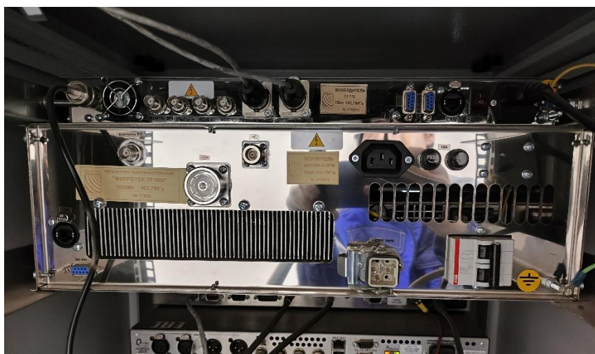
Рисунок 5 – Задняя панель усилителя со всеми произведенными отключениями
