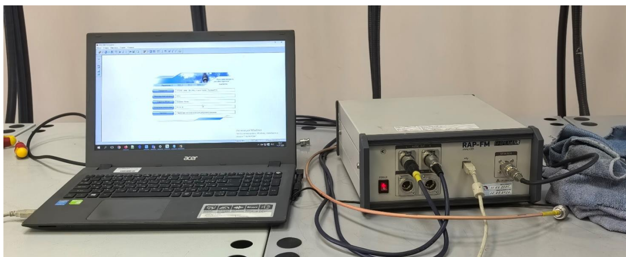
Рисунок 11 – Ноутбук со специальным ПО и анализатор RAP-FM
