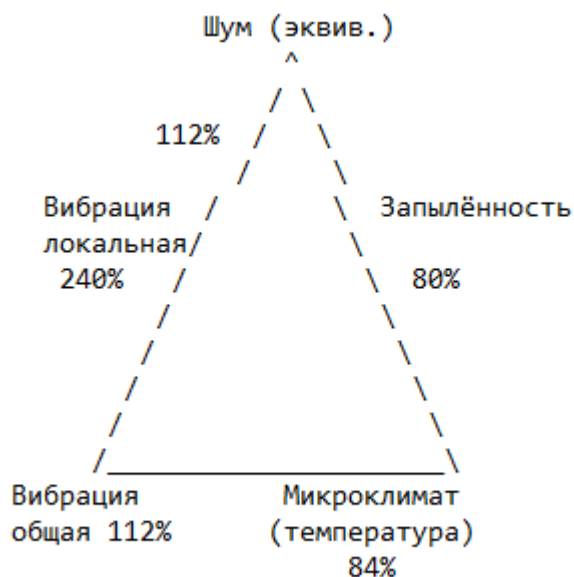
Рисунок 3 – Процентное отношение фактических значений к ПДУ для рабочего места машиниста буровой установки (ось 100% – линия ПДУ)
