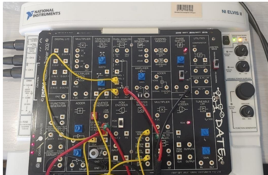
Рисунок 3 – Рабочая схема для генерации ASK сигнала (100 кГц) Осциллограммы цифрового сигнала и ASK сигнала зафиксированы (рисунок 4).
