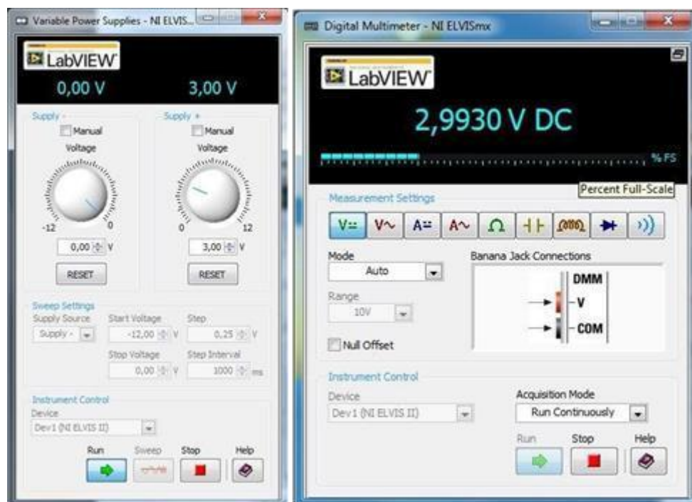
Рисунок 1.2 – Результаты измерения положительного напряжения
