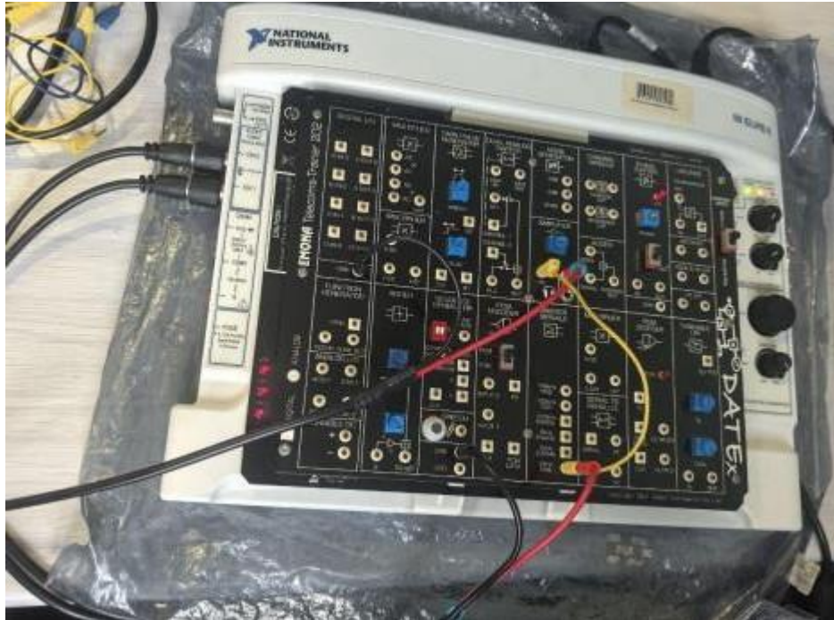
Рисунок 2.1 – Схема с модулем Amplifier
