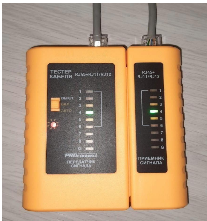
Рисунок 3 – Результат проверки тестером кабеля
