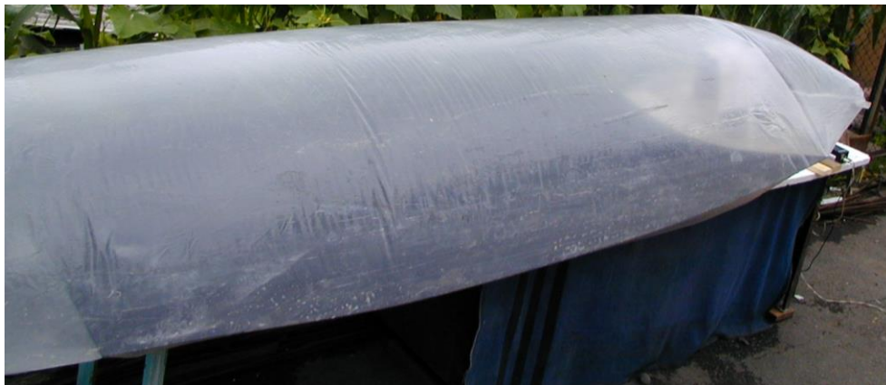
Рис. 1. Надувной воздушный гелиоколлектор
