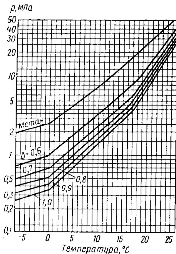
Рис. 1. Условия образования гидратов для газов различной плотности [1]
