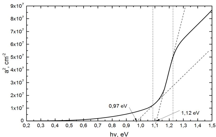
Рис. 4. Схема расчета ширины запрещенной зоны – прямые переходы
