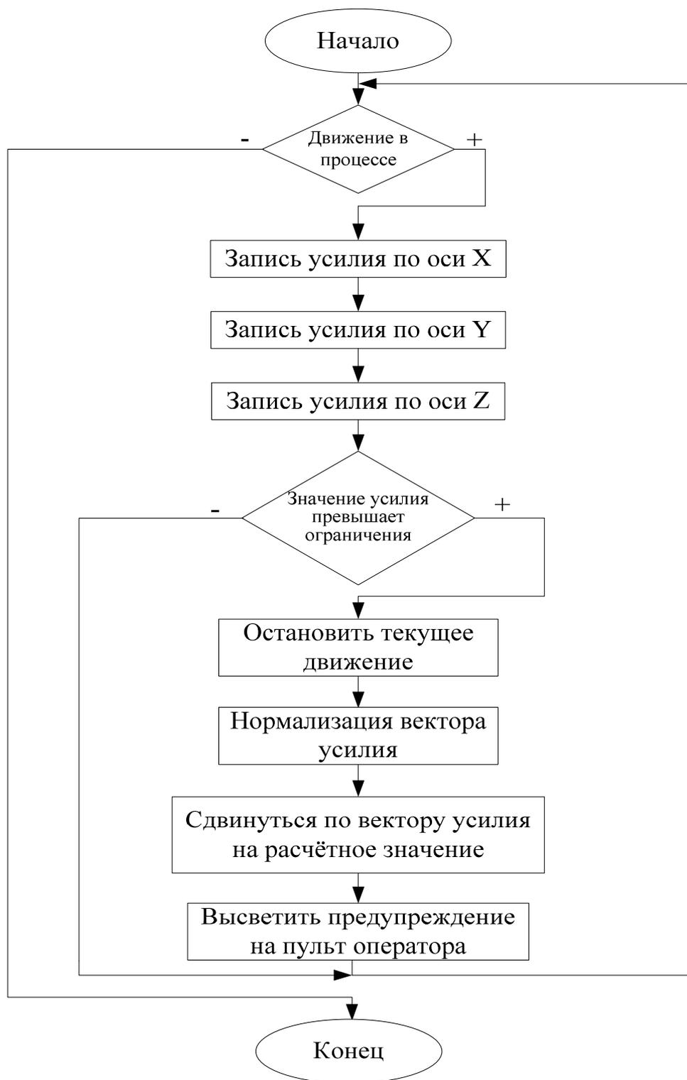
Рис. 2. Алгоритм обработки внешних усилий
