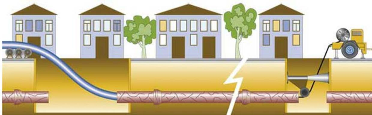
Рис. 1. Метод замены участка трубопровода «Труба в трубе»
