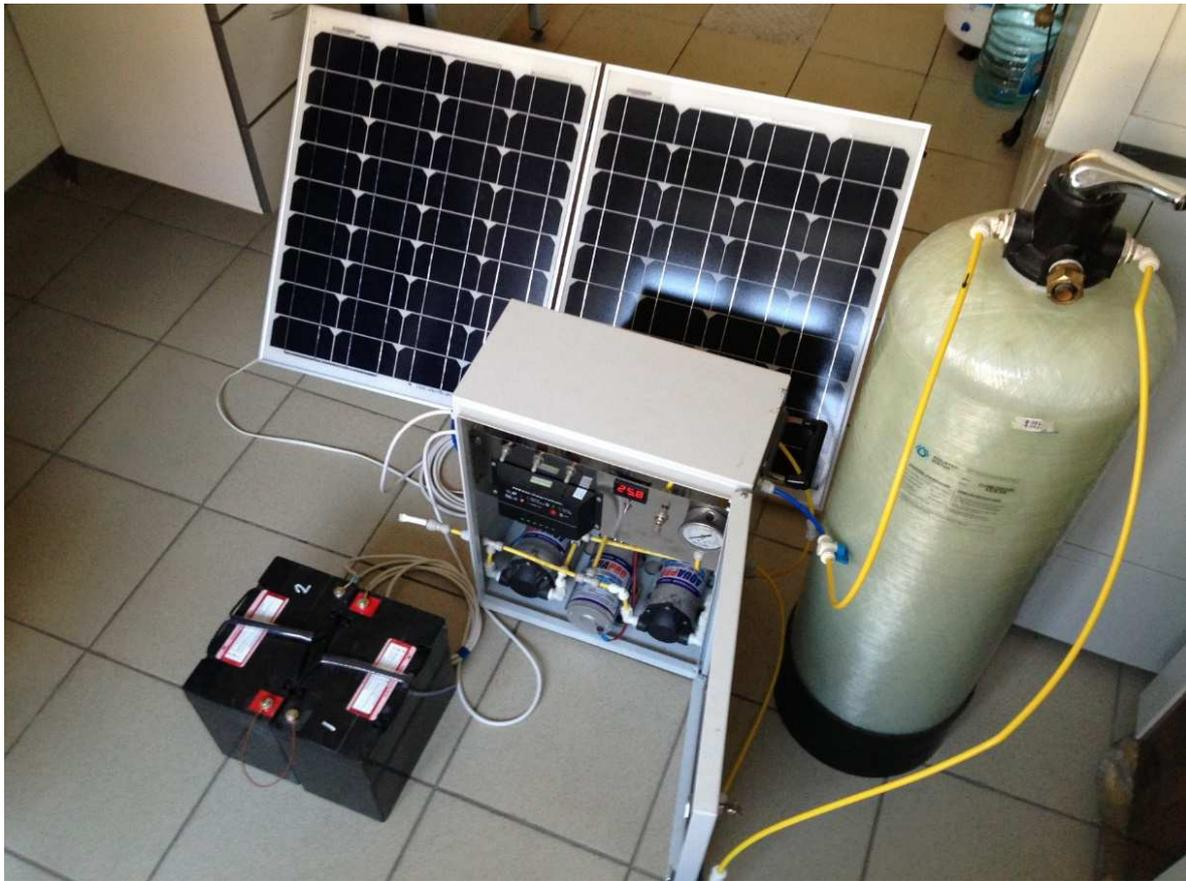
Рис. Мобильная обратно-осмотическая установка с питанием от солнечных панелей
