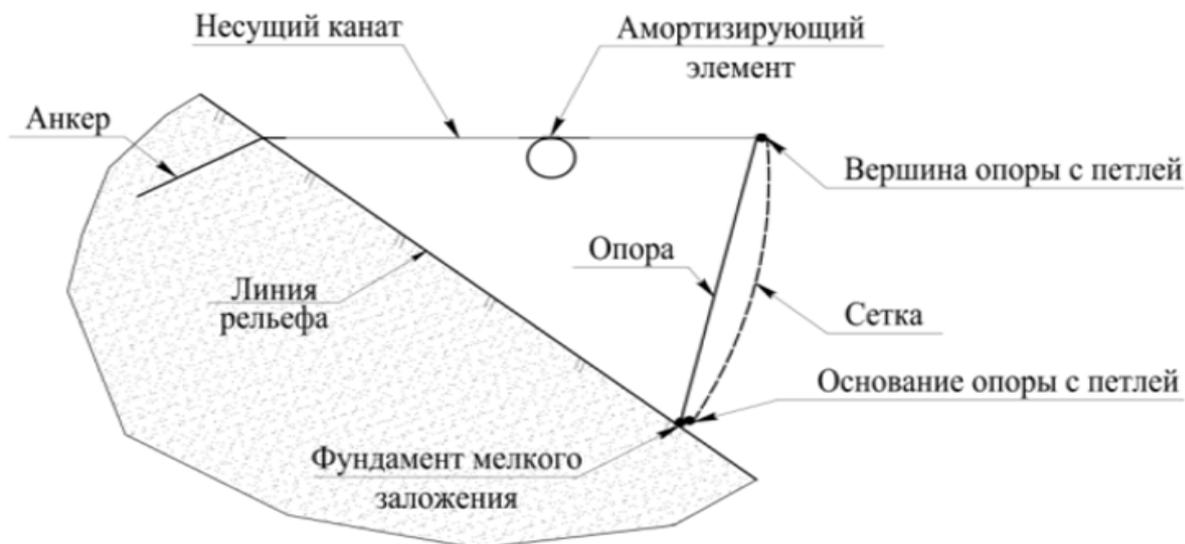
Рис. 1. Схематичный вид гибкого противокамненного барьера.
