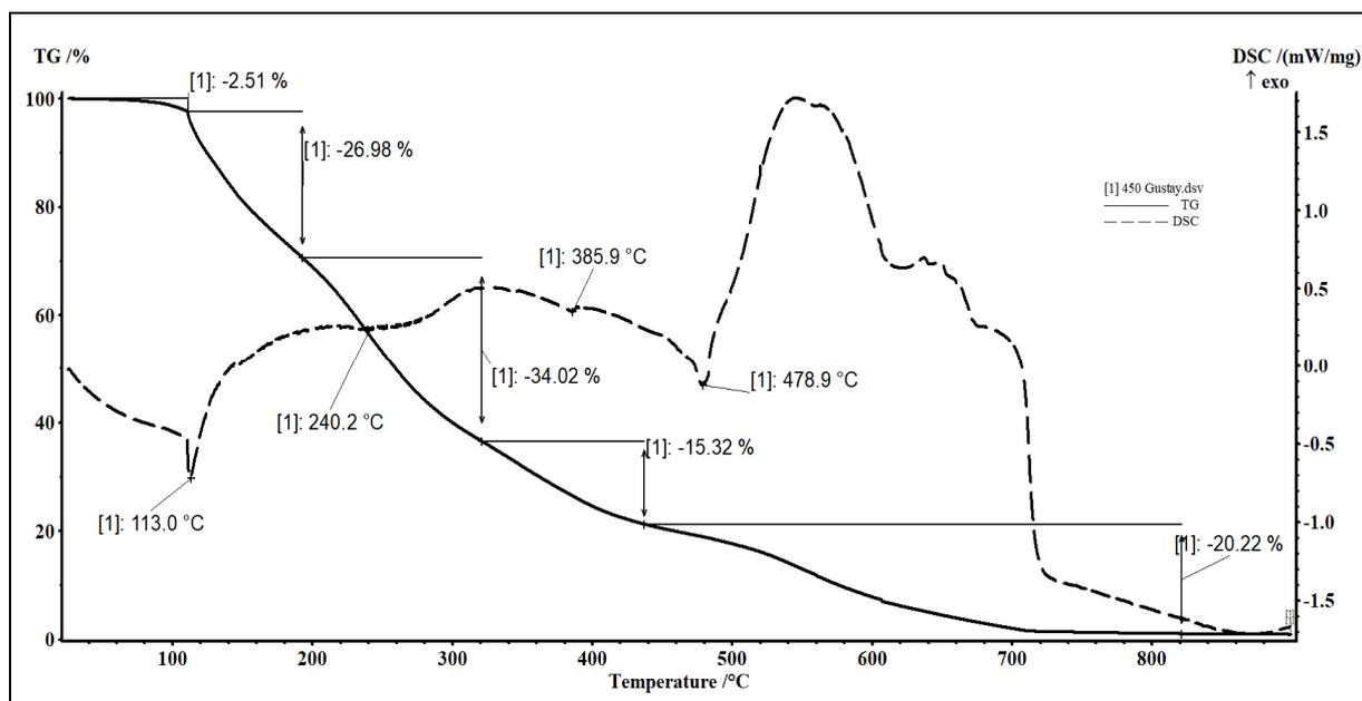
Рис. 3. Термограмма образца тяжелой фракции
