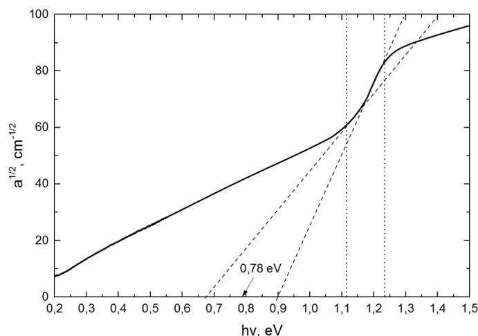
Рис. 3. Схема расчета ширины запрещенной зоны – непрямые переходы
