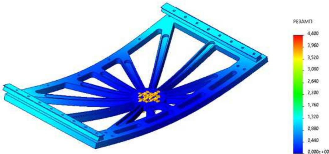
Рис. 7. Вид деформированной модели стенки с направляющими
