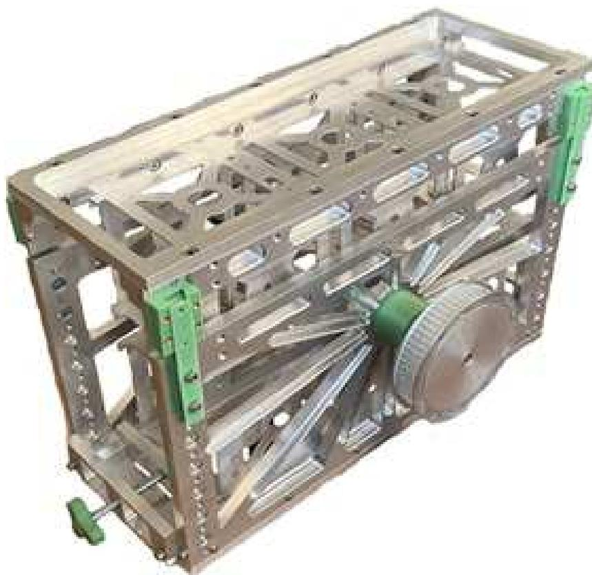
Рис. 2. Фотография разработанного в НОЦ им. К.Э. Циолковского АмГУ ИТПК для спутников CubeSat 6U
