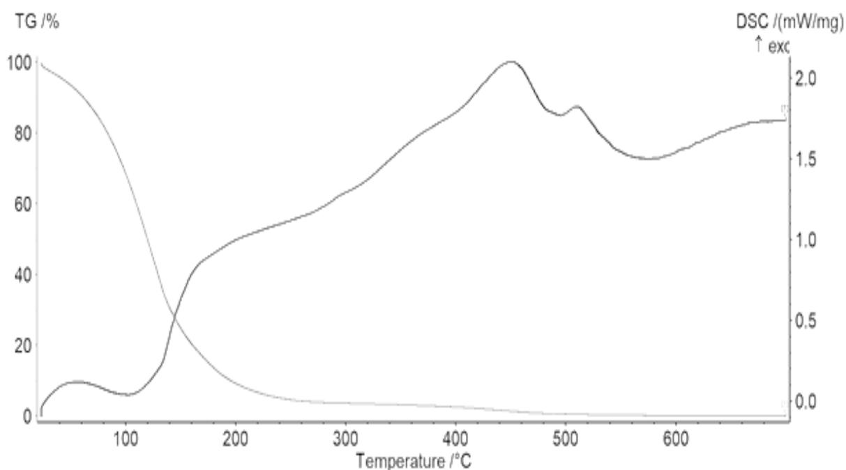
Рис. 1. Термограмма пиролизной жидкости из эпоксидвинилэфирной матрицы
