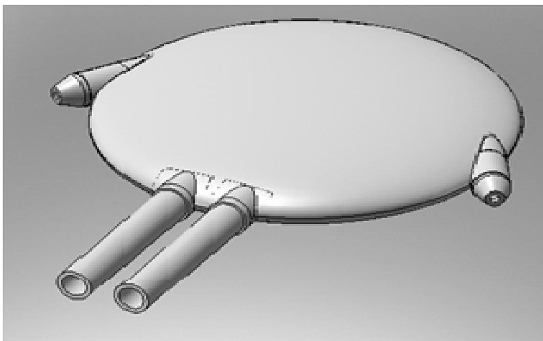
Рис. 1. Модель подводного устройства для распыления сорбента
