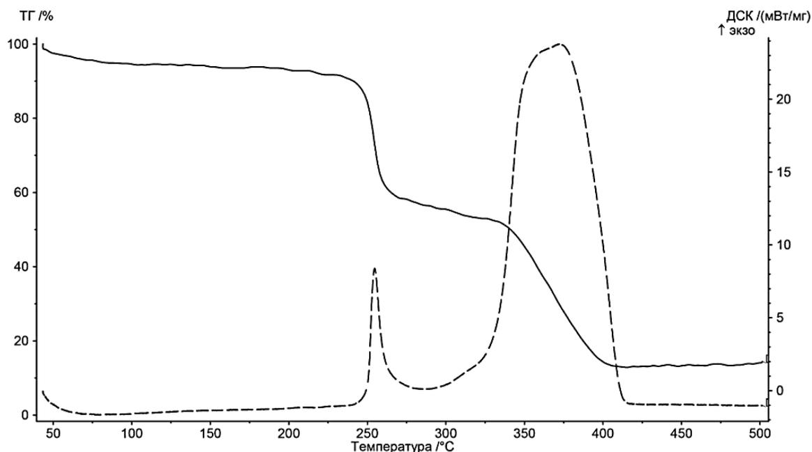
Рис. 2. Термогравиграмма  $[\text{CoL}_2(\text{NO}_3)_2] \cdot 0.5\text{H}_2\text{O}$  (II)
