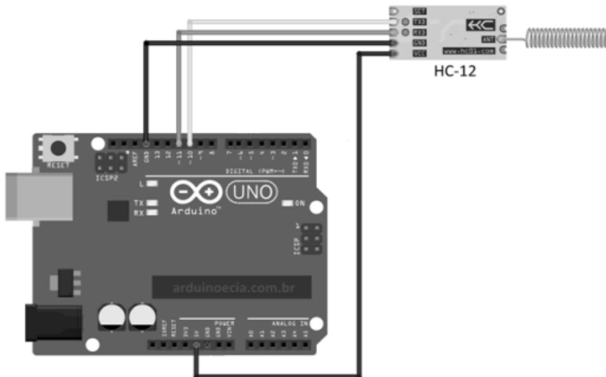
Рис. 3. Схема приёмопередатчика
