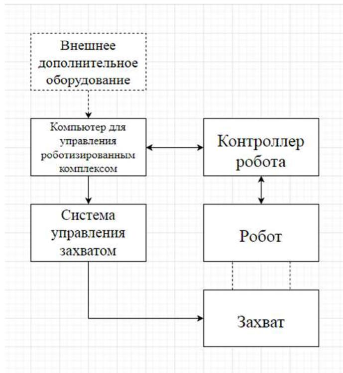
Рис. 1. Структура роботизированного комплекса
