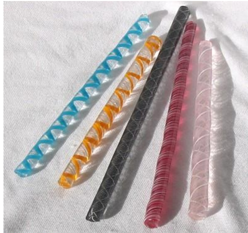
Рис.6. Заготовленные стеклянные трости, для дальнейшего нарезания на диски
