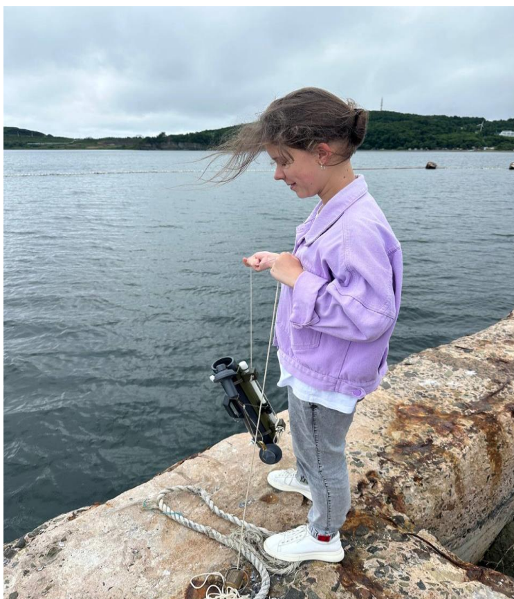
Рис. 6 Процесс применения прибора для взятия проб воды (батометра)
