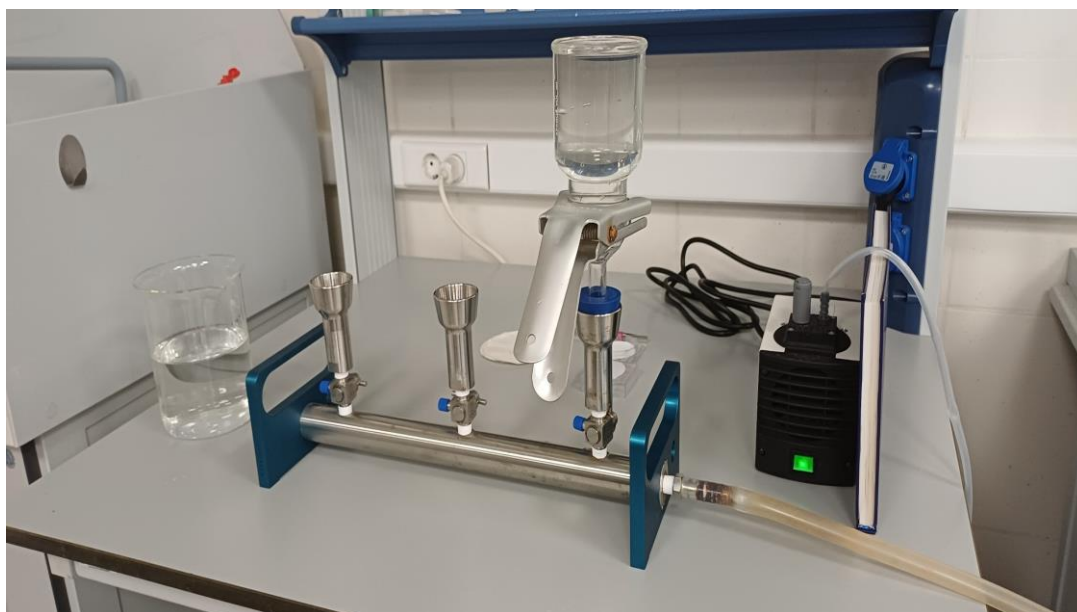
Рис 4. Лабораторный прибор вакуумного фильтрования (вакуумная фильтрационная гребёнка)
