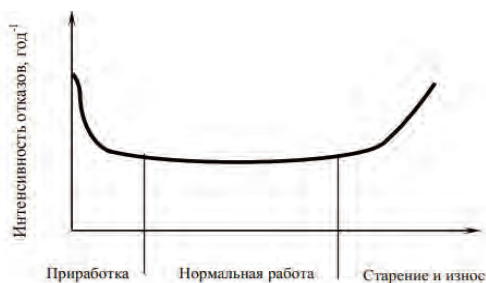
Рисунок 1 - Изменение интенсивности отказов в течение эксплуатационного периода
