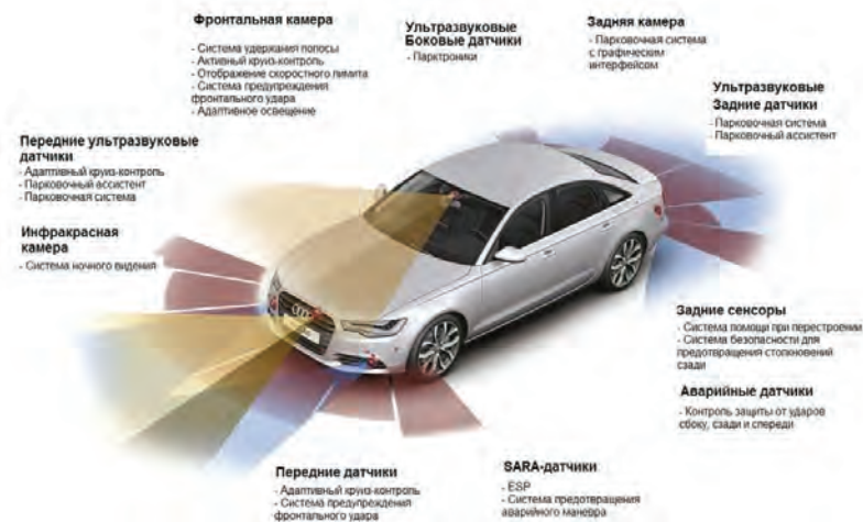
Рис. 1. Система активной безопасности автомобиля
