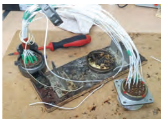
Рисунок 2. Электрожгут на стадии проверки
