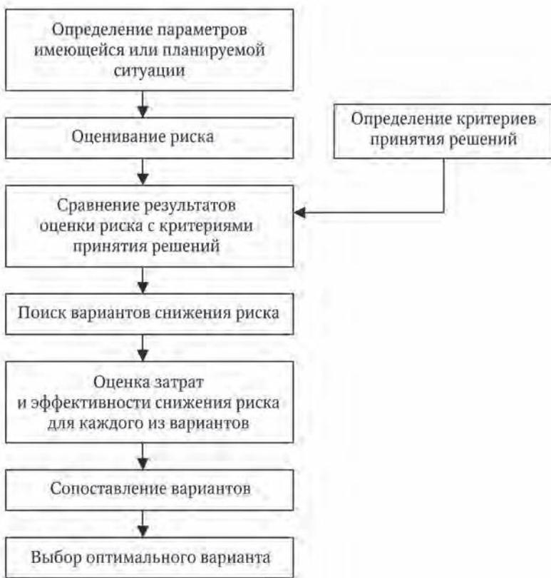
Рис. 7.2. Схема процесса управления риском
