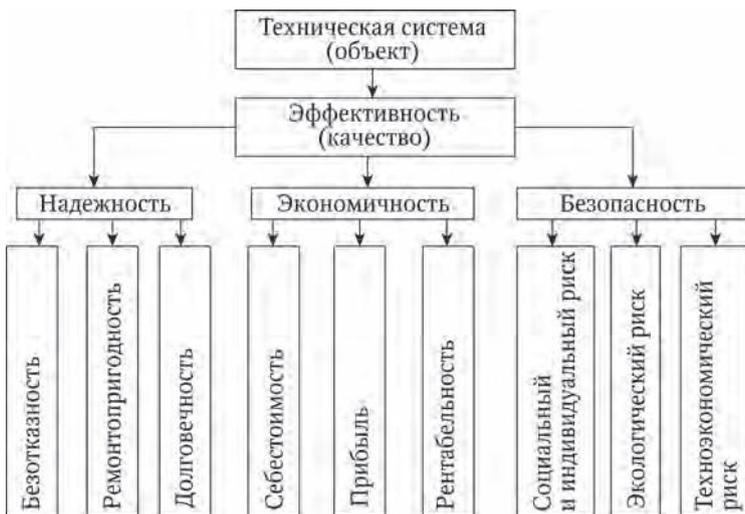
Рис. 4.1. Основные свойства технических систем
