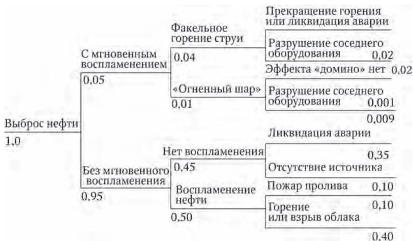
Рис. 4.6. «Дерево событий» аварий на установке первичной переработки нефти
