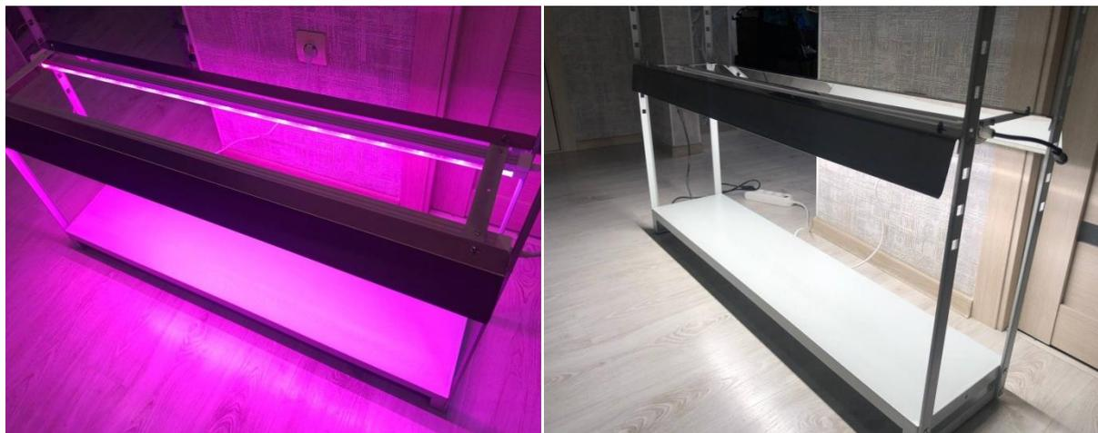
Рисунок 1 — Слева светильники full-spectrum длиной 120 см и мощностью 19,6 Вт, справа линейный светильник SPP-3-20-6K-M мощностью 20 Вт
