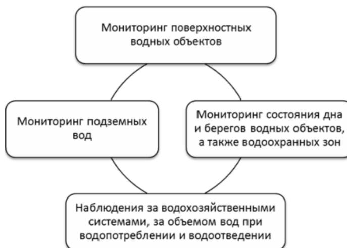
Рисунок 1 - Подсистемы в мониторинге водных объектов
