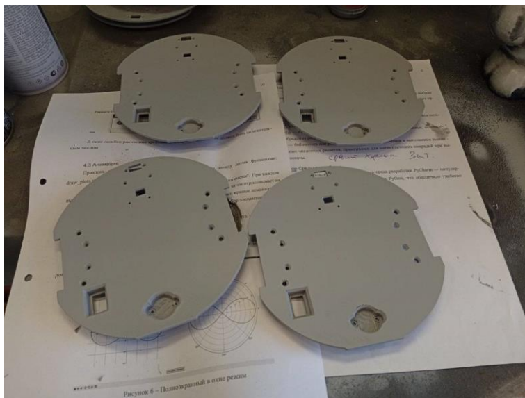
Рисунок 1 – пластиковая деталь после черновой механической обработки
