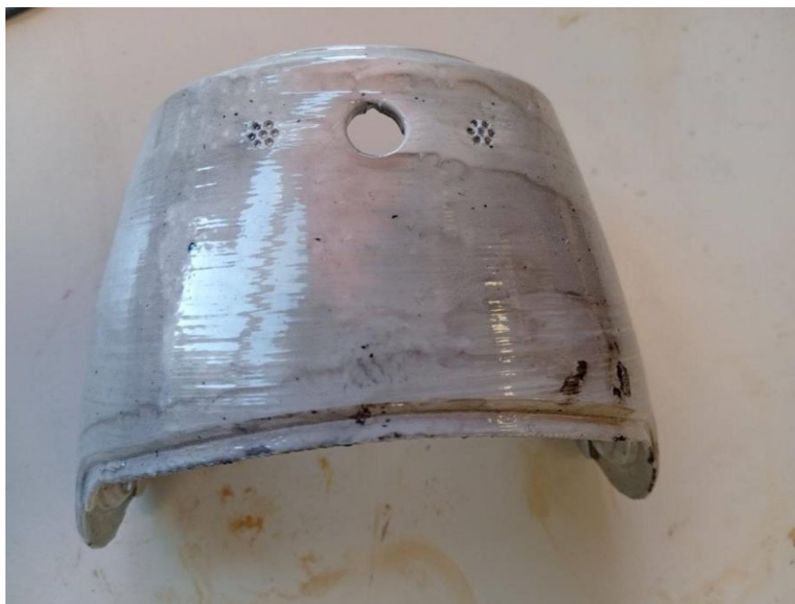
Рисунок 3 – пластиковая деталь после обработки ацетоном
