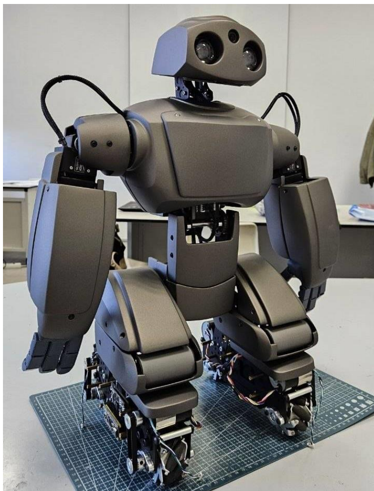
Рисунок 4 – «АДАМ» в пластиковом корпусе после покраски и лакировки
