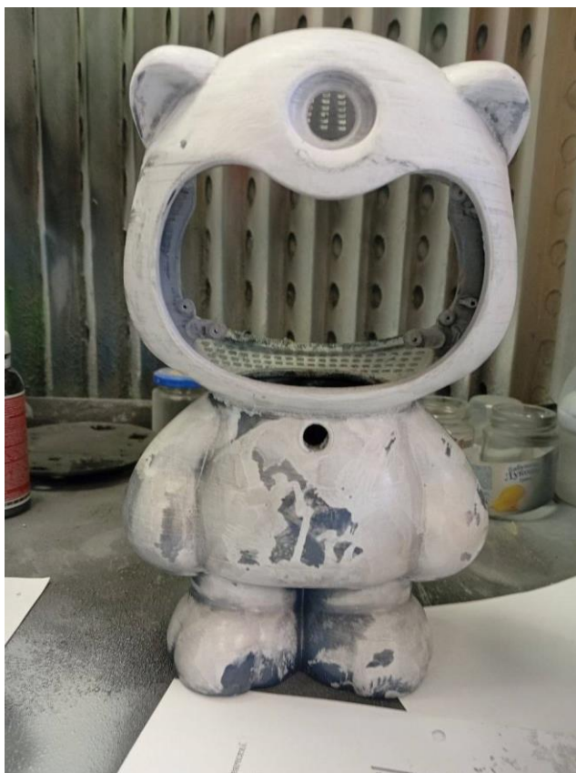
Рисунок 2 – пластиковый корпус после шлифовки
