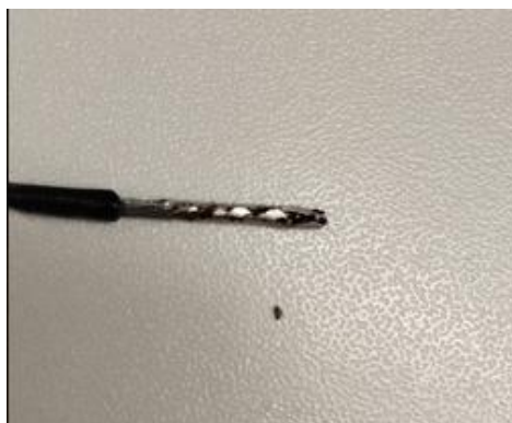
Рисунок 3.3 - Лужение провода. Без скручивания
