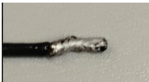
Рисунок 3.4 - Лужение провода. Со скручиванием
