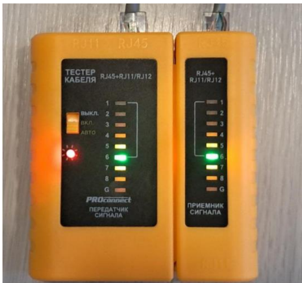
Рисунок 2.4 – Результат проверки тестером кабеля
