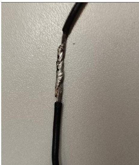
Рисунок 3.5 - Скручивание двух проводов и их пайка
