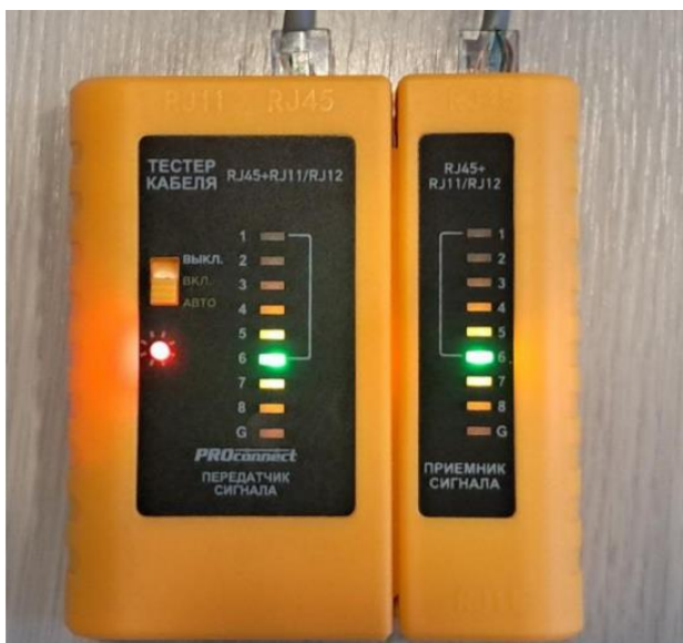
Рисунок 2.3 – Результат проверки тестером кабеля
