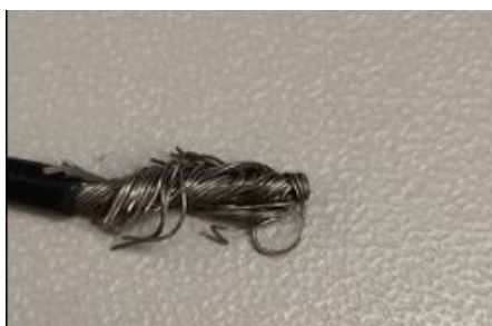
Рисунок 3.2 - Снятие изоляции с провода. Со скручиванием
