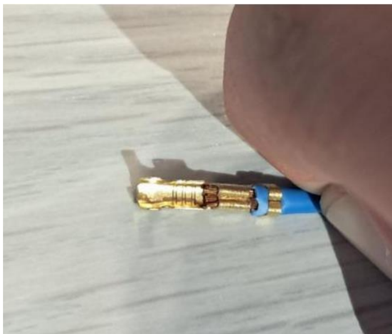
Рисунок 2 - контактное соединение с использованием наконечника и пресс-клещей
