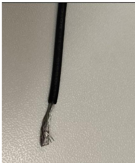
Рисунок 3.1 - Снятие изоляции с провода. Без скручивания
