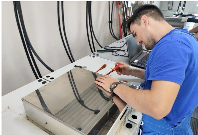
Рисунок 42 - Снятие верхней крышки усилителя
