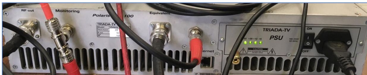
Рисунок 30 - Подключение усилителя в схему передатчика
