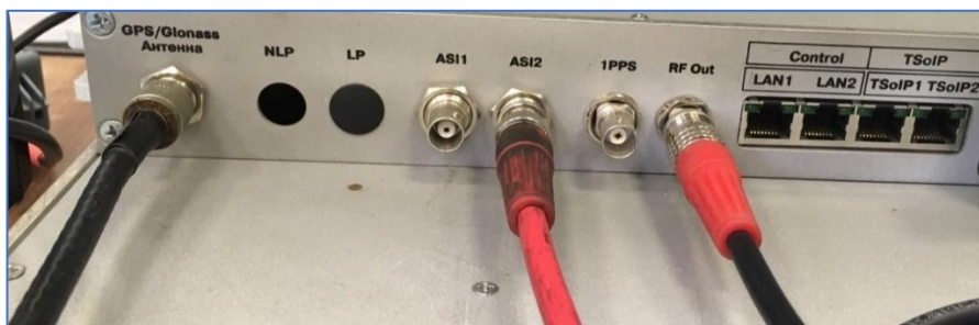
Рисунок 29 - Подключение ФТС в схему передатчика
