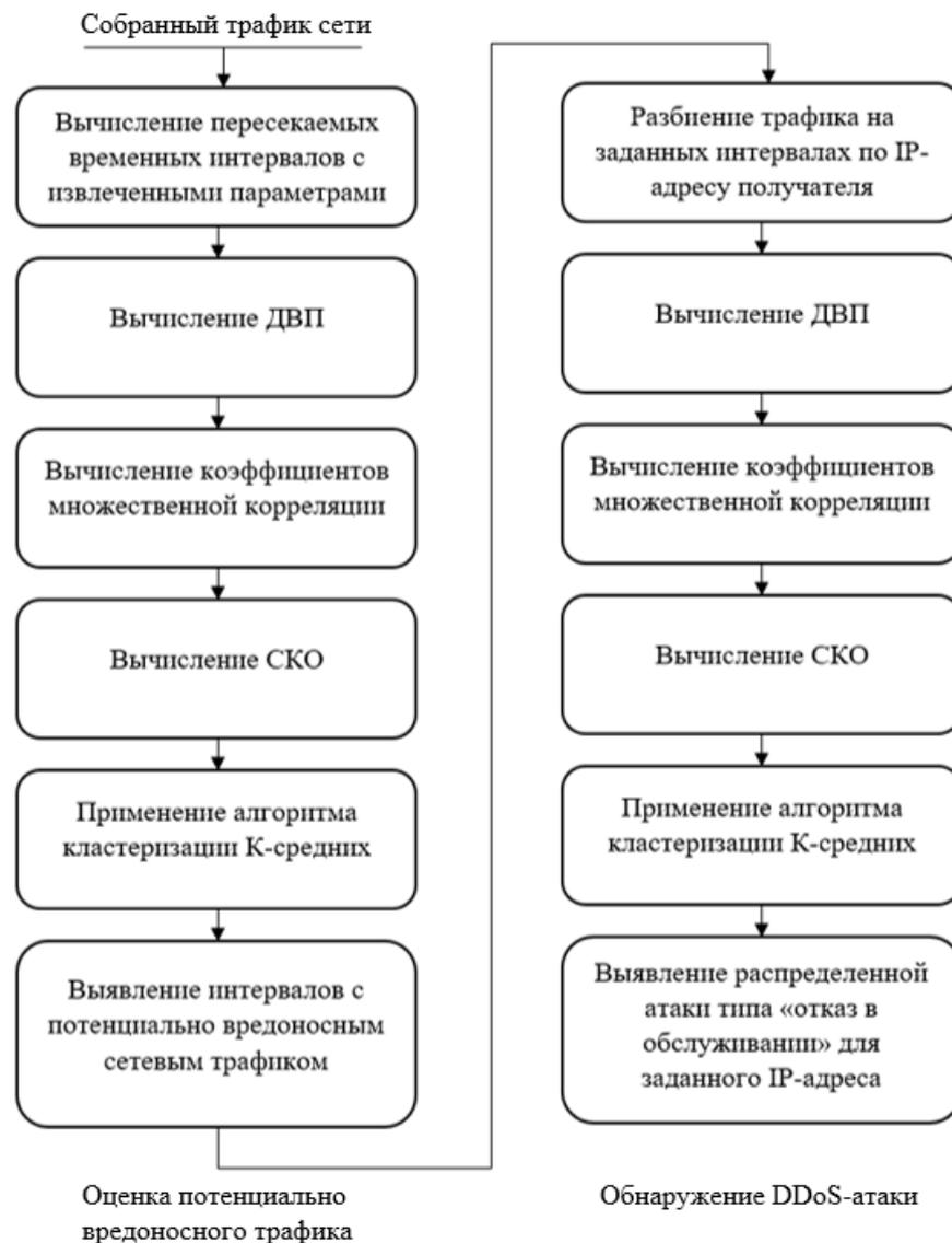
Рис. 2 – Схема работы интервального метода
