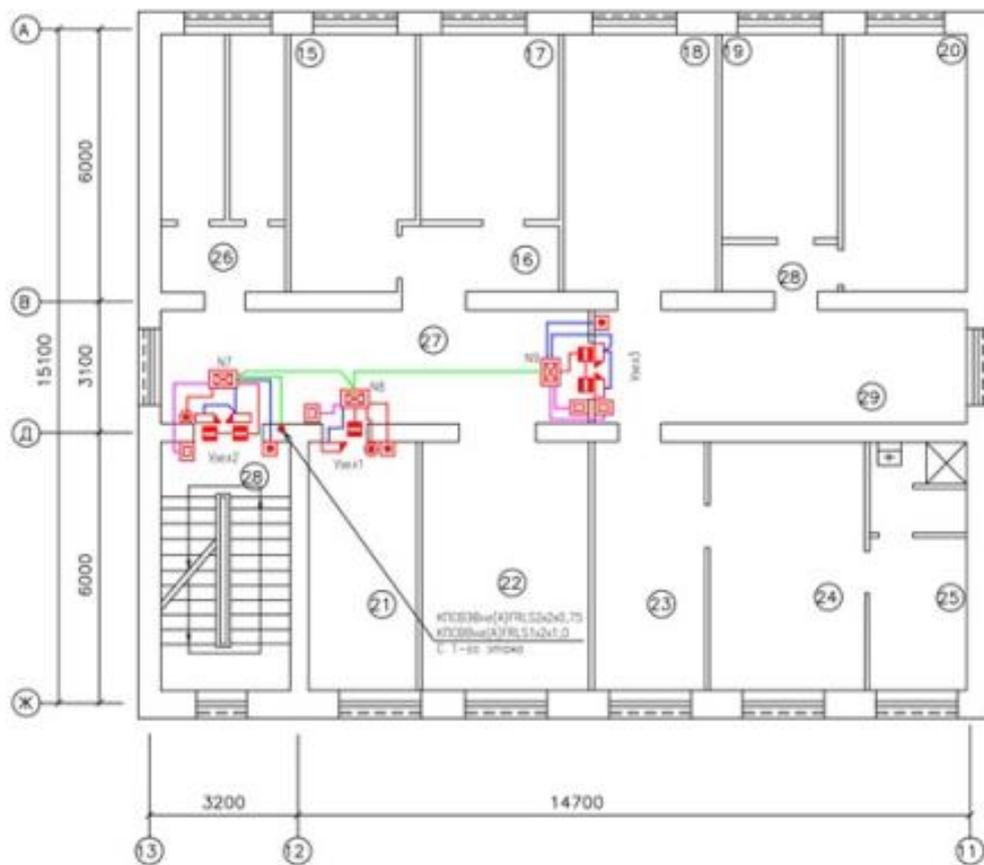
Рис.4 План расположения оборудования и кабельных коммуникаций на 2 этаже
