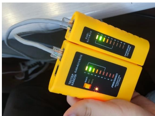
Рисунок 4 – Проверка в тестере-кабеля
