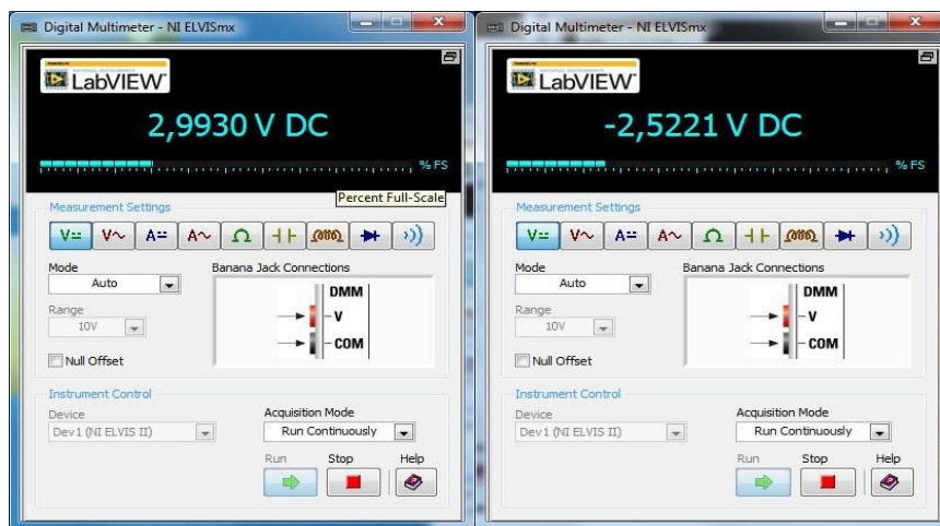
Рисунок 1 – Показания мультиметра с положительным и отрицательным напряжением Подключил функциональный генератор в режиме Manual (рис. 2).
