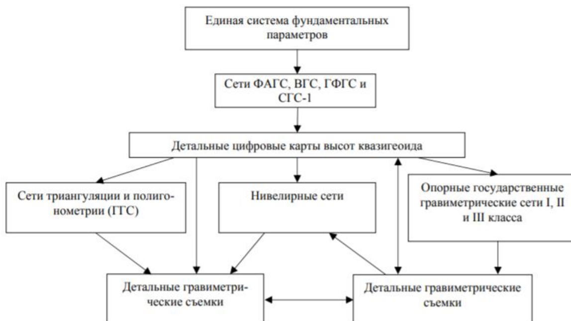
Рис. 2. Новая структура системы геодезического обеспечения на основе одной системы фундаментальных параметров
