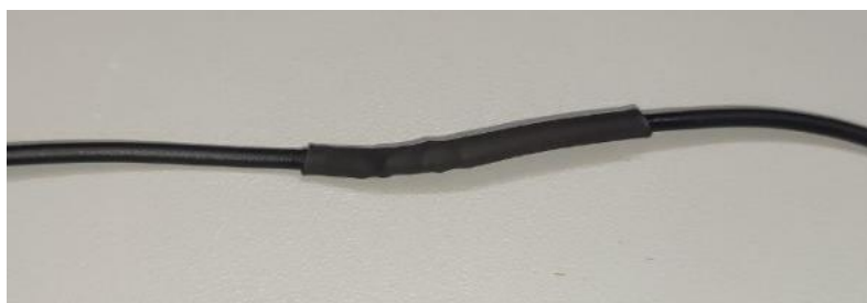
Рисунок 3 – Наложение изоляции на место пайки
