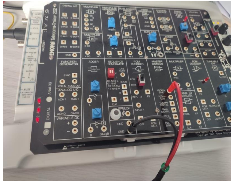
Рисунок 2.1 – Схема подключения (Master Signals 100 kHz SINE)
