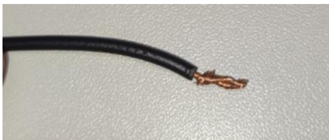
Рисунок 1.2 – Снятие изоляции с провода (со скручиванием)
