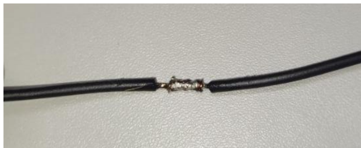
Рисунок 3.2 – Пайка двух соединенных скрученных проводов
