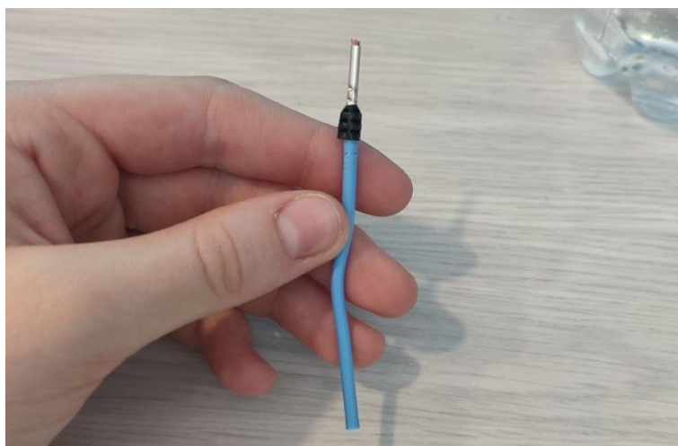
Рисунок 2 – Контактное соединение с использованием наконечника и пресс-клещей
