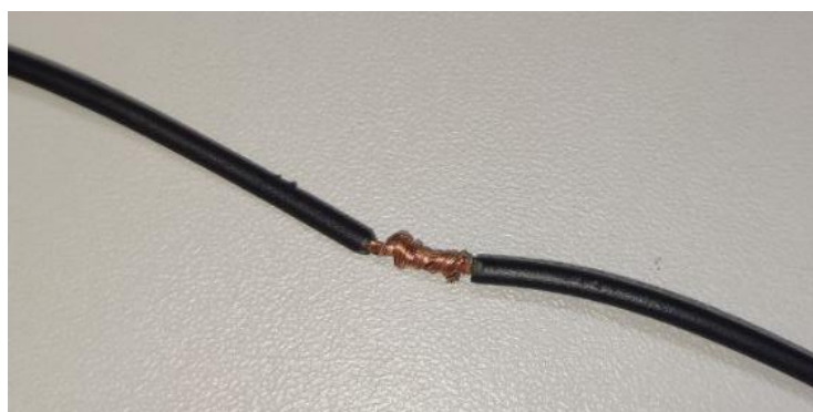
Рисунок 3.1 – Скручивание двух проводов
