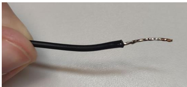
Рисунок 2.1 – Лужение провода (без скручивания)
