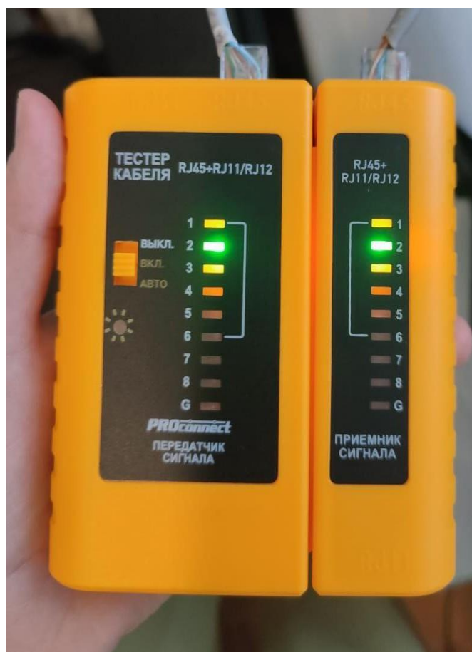
Рисунок 4 – Результат проверки тестером кабеля
