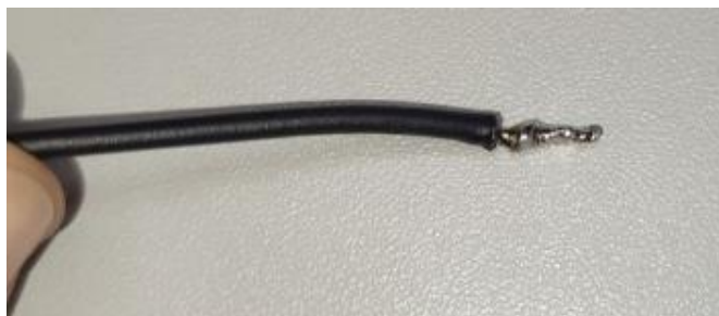
Рисунок 2.2 – Лужение провода (со скручиванием)
