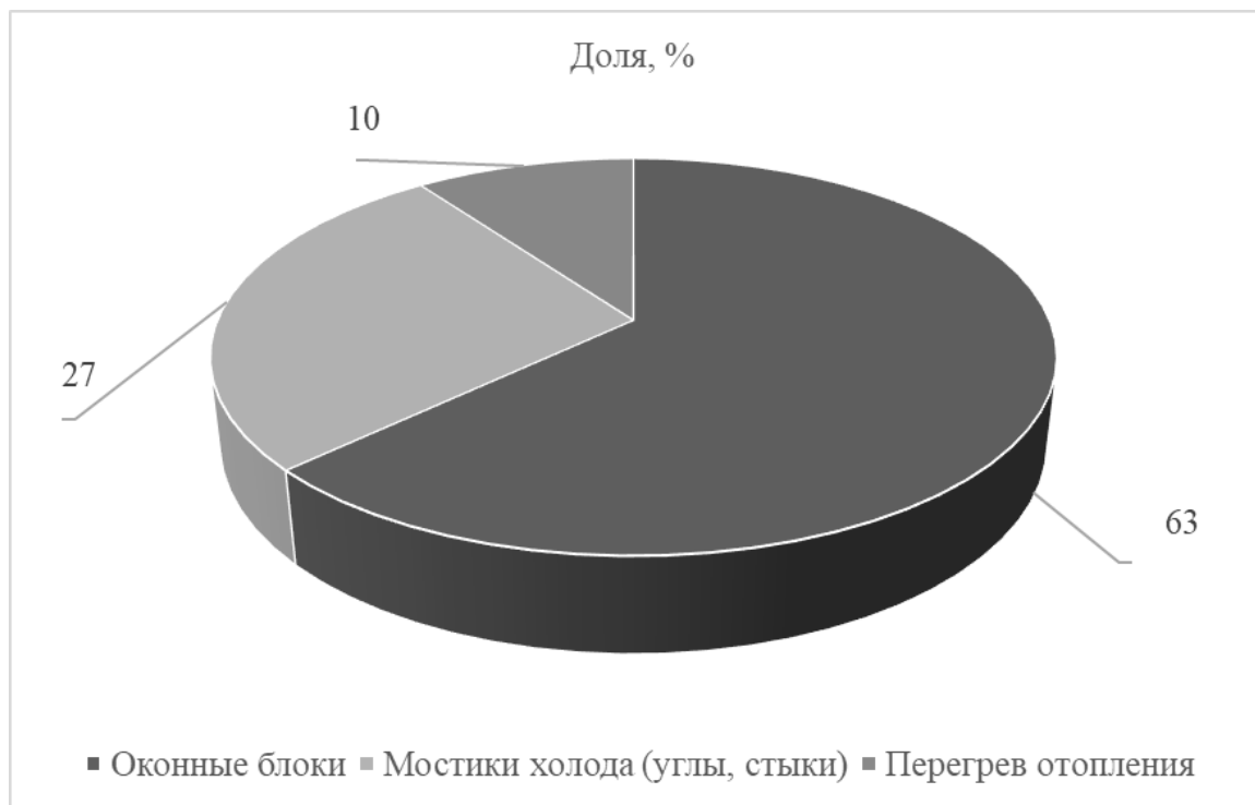
Рис. 1. Распределение выявленных тепловых дефектов по типам (диаграмма)
