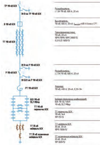
Рисунок 1 – Ячейка с БСК 110 Кв
