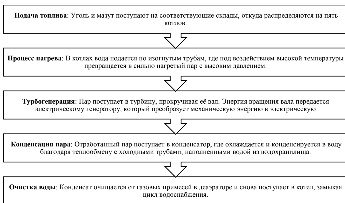
Рисунок 3 - Краткая схема технологического процесса Партизанской ГРЭС
