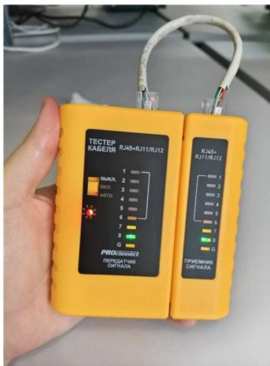
Рисунок 3.9 – Проверка соединения тестером кабеля
