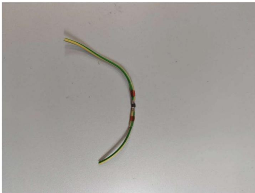
Рисунок 3.3 - Соединение с помощью термоусадочной трубки с припоем.
