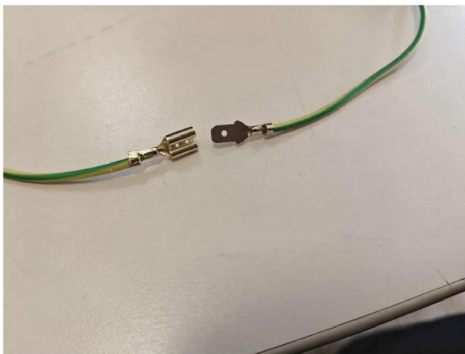
Рисунок 3.2 – Обжатый штырь и гнездо
