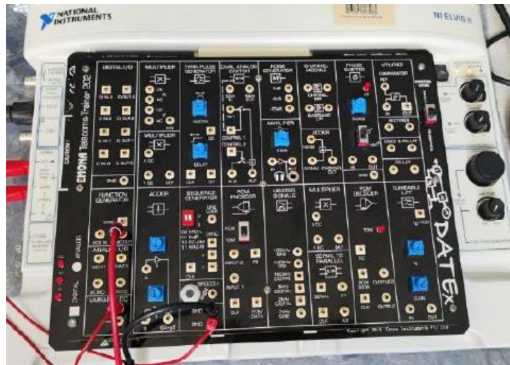
Рисунок 11 схема подключения генератора функций
