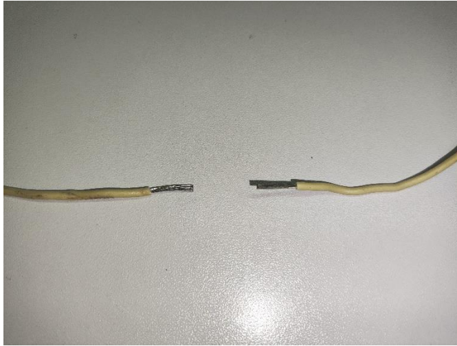
Рисунок 33 два провода со снятой изоляцией
