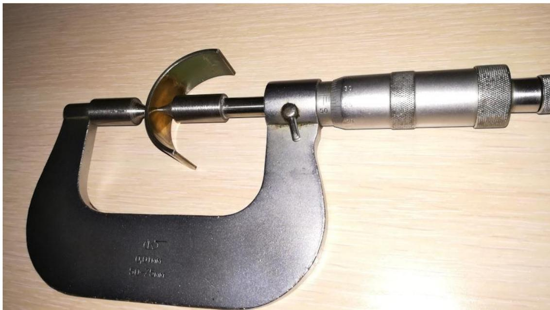
Рисунок 10 – Микрометр
