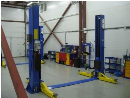
Рисунок 2 – Гидравлический подъемник
