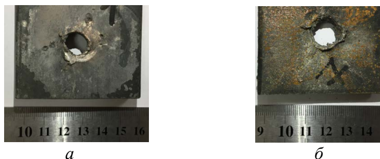
Рис. 2. Внешний вид входного отверстия пластин: а – входное отверстие, полученное после испытаний со штатной облицовкой; б – входное отверстие, полученное после испытаний с экспериментальной облицовкой
