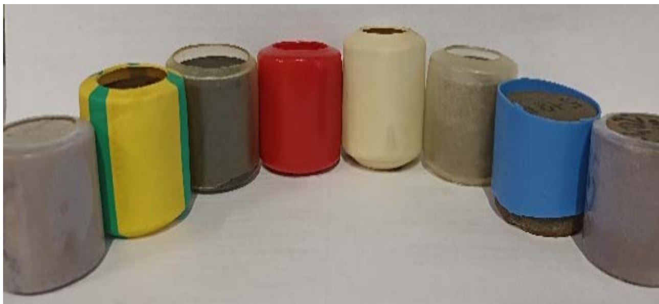
Рис. 1. Образцы в термоусадочной пленке после воздействия растворителя
