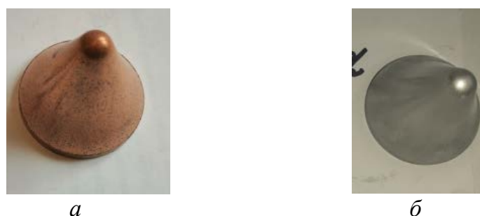
Рис. 1. Внешний вид изготовленных кумулятивных облицовок: а – облицовка из Cu (88 %) + Pb (12 %) + масло индустриальное (4 %); б – облицовка из Al (20 %) + Ni (50 %) + Cu (30 %)
