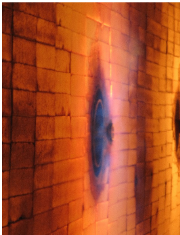
Рисунок 1 – Работа вихревых плоскопламенных горелок при испытании в печи и распространение факела по кладке печи
