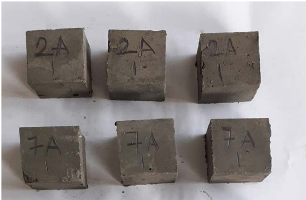
Рисунок 1. Образцы тампонажного камня используемые в экспериментах
