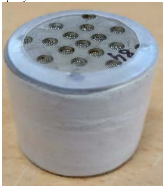
Рис. 2. Образец в термоусадочной трубке из PTFE (Adtech FHS32)
