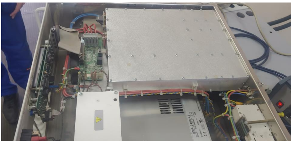
Рисунок 8 - разобранный корпус усилителя
