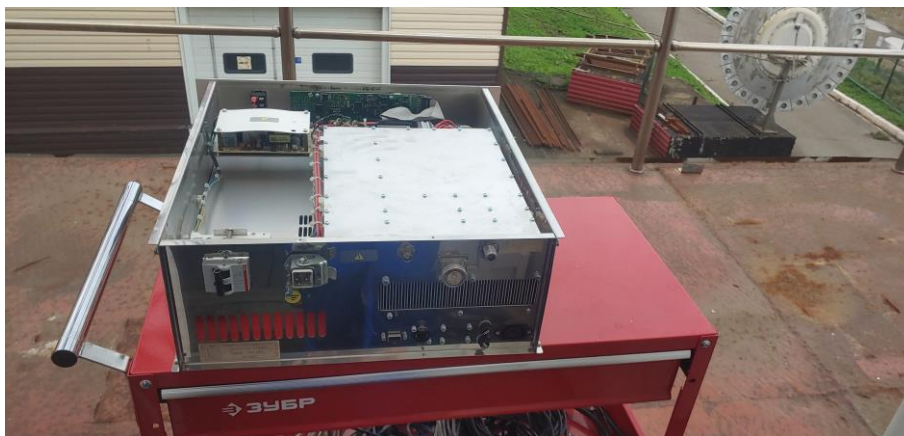
Рисунок 9 - произведён обдув внутренних элементов
