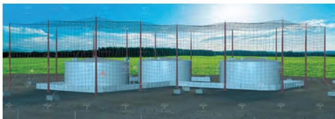
**Рисунок 7.** Вариант защитной инженерной конструкции, состоящей из стальной сетки, натянутой на вертикальные опоры (мачты, стойки) [18]
