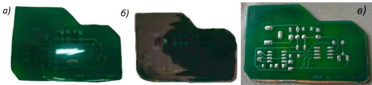
Рисунок 24 – Поверхность платы на стадии: а – покрытия паяльной маской; б – термической сушки паяльной маски; в – светового дубления
