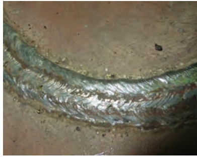
а) ручная дуговая наплавка
