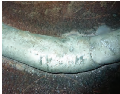
б) автоматическая наплавка под слоем флюса
