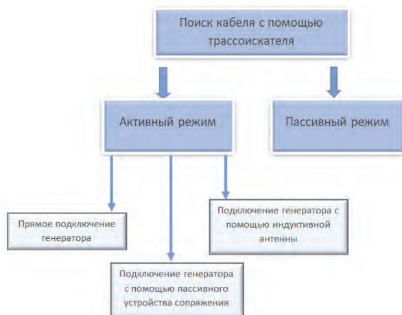
Рис. 1 Схема поиска подземных коммуникаций с помощью трассопоискового оборудования
